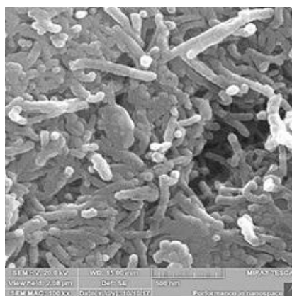
Рисунок 11 - Микрофотографии порошков: а) каолин марки "технический», б) диоксид титана, в) порошок из УНТ
