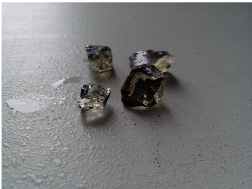
Рисунок 39 – Внешний вид буры после нагрева до 950°С
