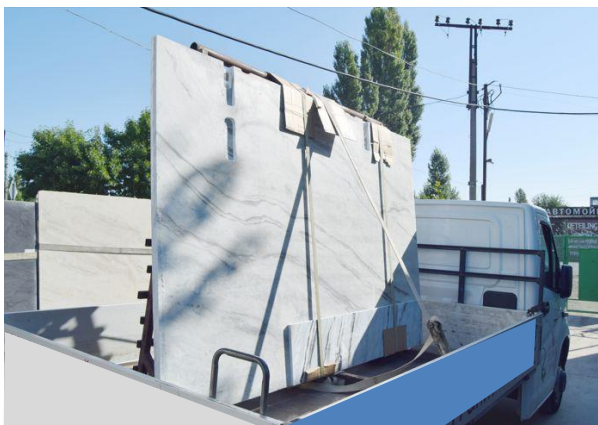
Рисунок Д.1 - Пример правильно связанной пирамиды подготовленной для транспортировки
