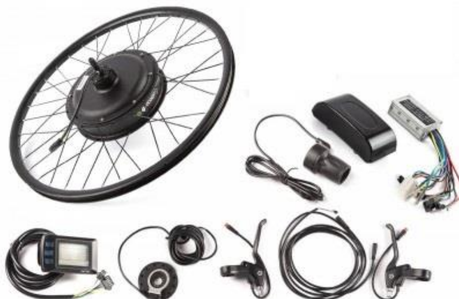
Рисунок 11 – Комплект для электрификации
