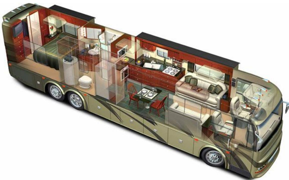
Рисунок 17 – Компоновка внутреннего пространства жилого модуля автобуса
