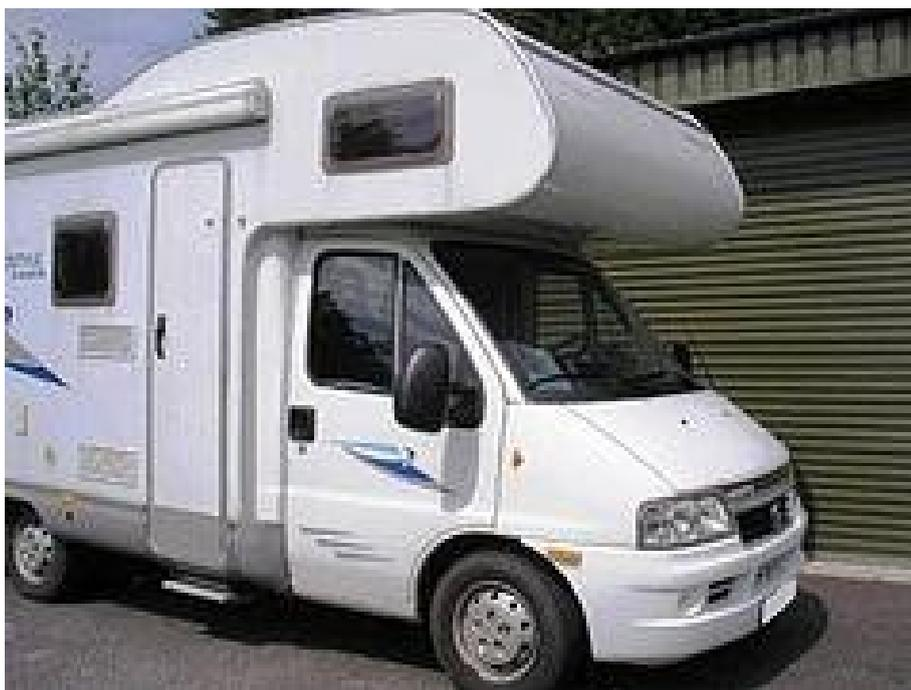
Рисунок 8 – Жилой модуль на шасси микроавтобуса Deslex Alkov
