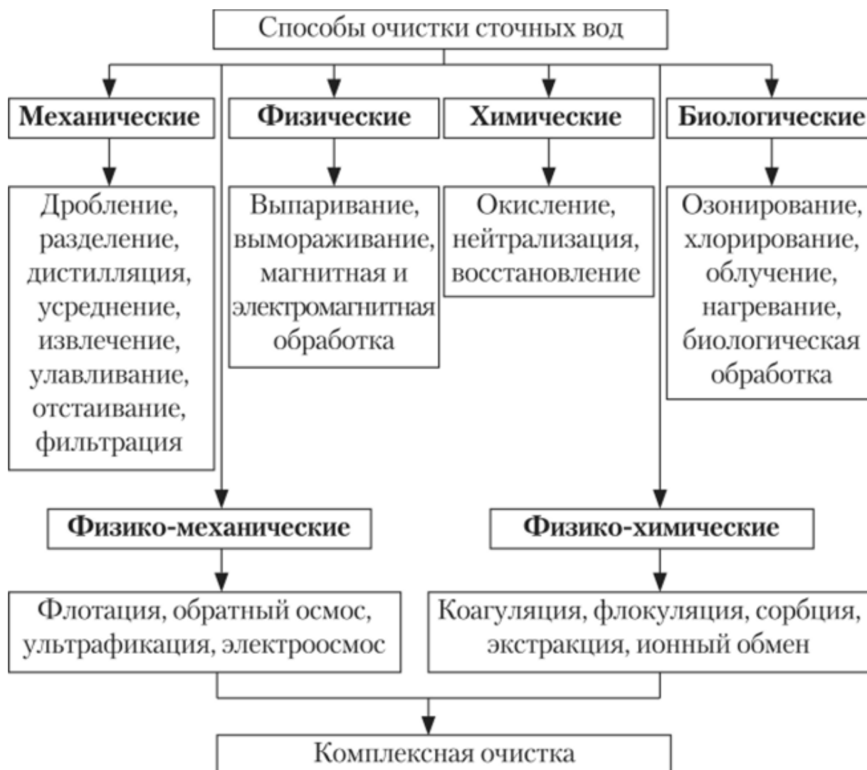
Рисунок 2 – Схема классификации способов очистки сточных вод
