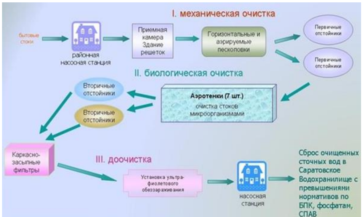
Рисунок 12 – Схема технологического процесса очистки сточных вод ООО «АВК»
