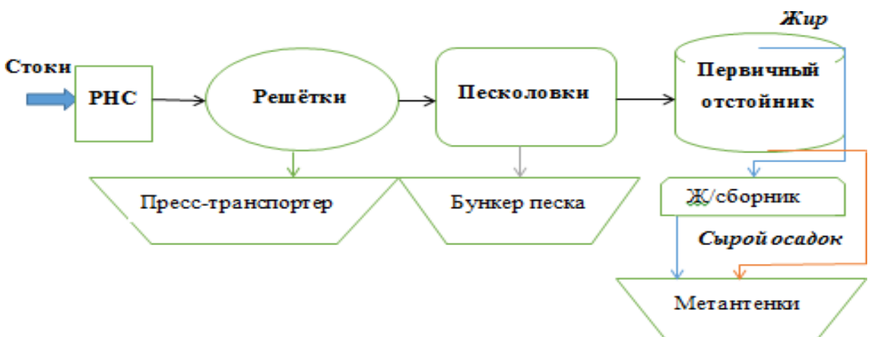
Рисунок 13 – Технологическая схема механической очистки сточных вод
