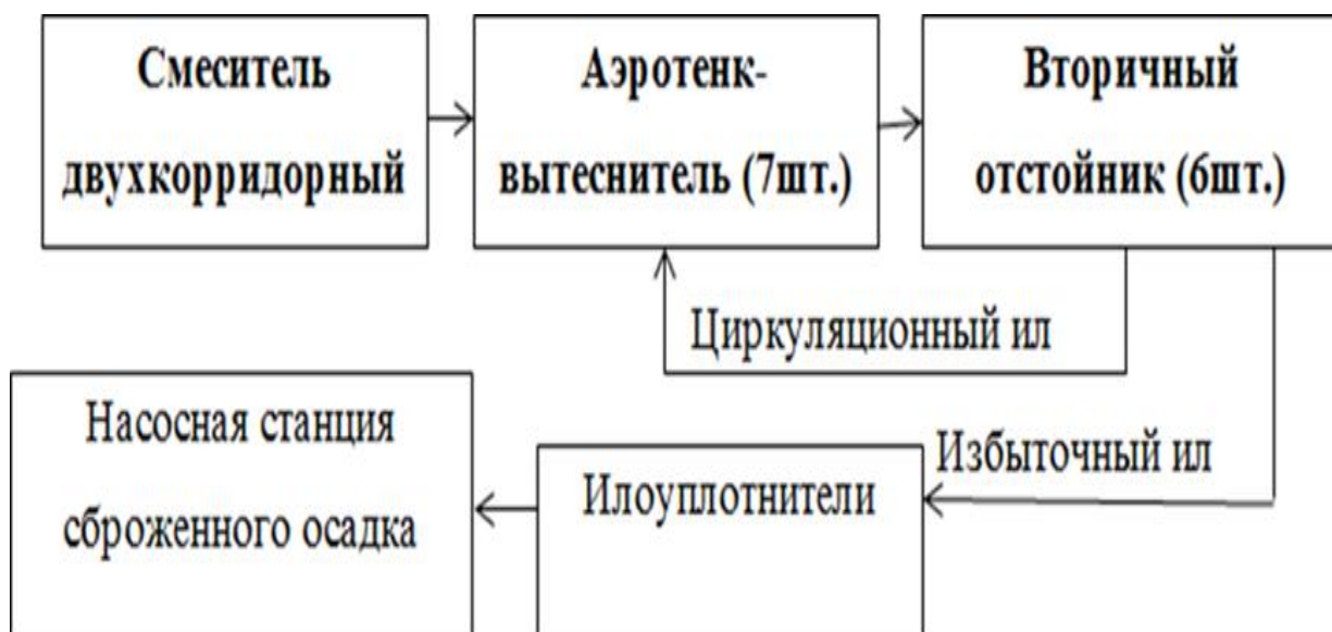
Рисунок 14 – Технологическая схема биологической очистки сточных вод
