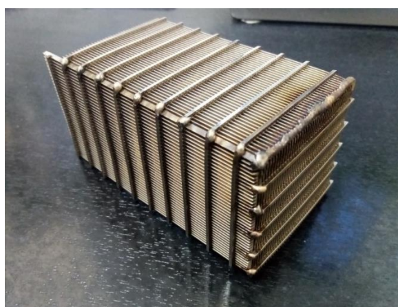
Рисунок 39 – Сварка плоских элементов
