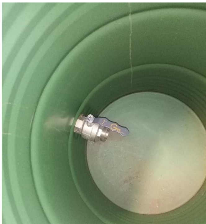
Рисунок 36 – Кран шаровой полнопроходной G2 внутри бочки
