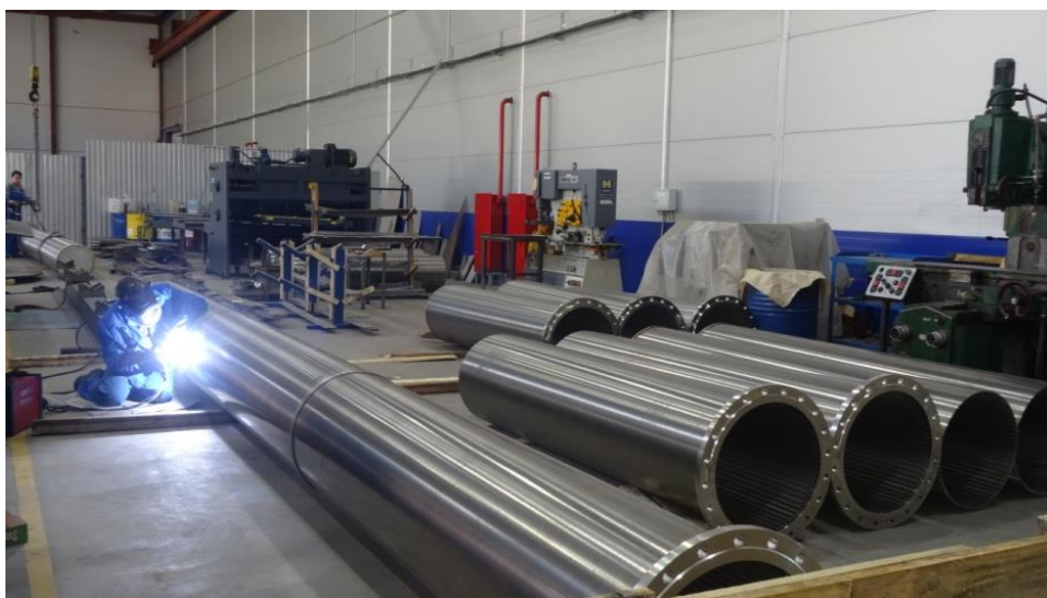
Рисунок 29 – Производство подруслового фильтрующего элемента из сегментов с кольцами жесткости
