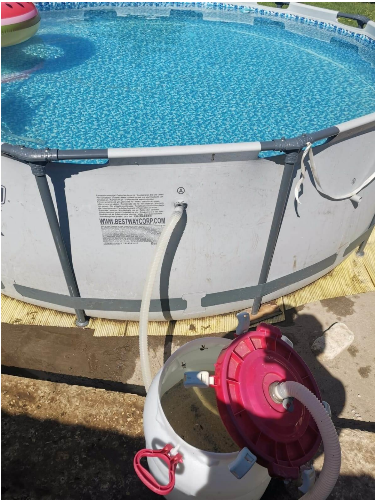
Рисунок 44 – Состояние фильтра после 18 часов эксплуатации при первичной очистке бассейна
