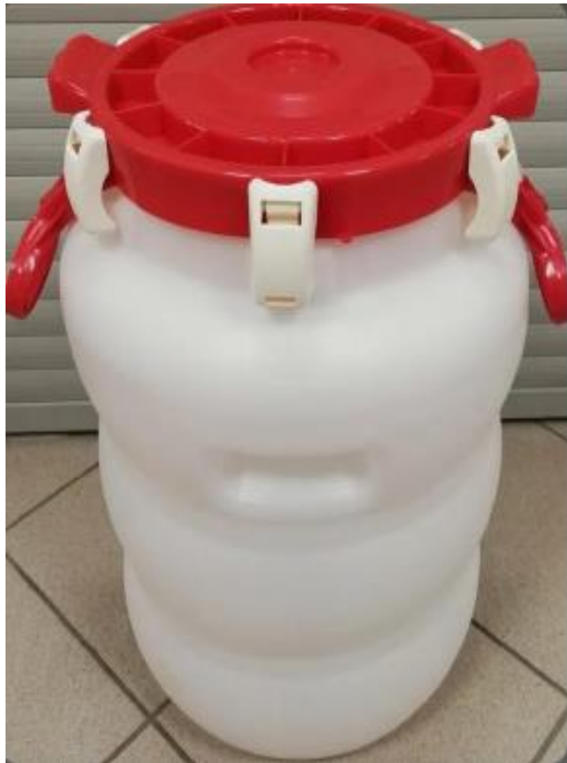
Рисунок 31 – Пластиковый резервуар на 60 литров для изготовления фильтра
