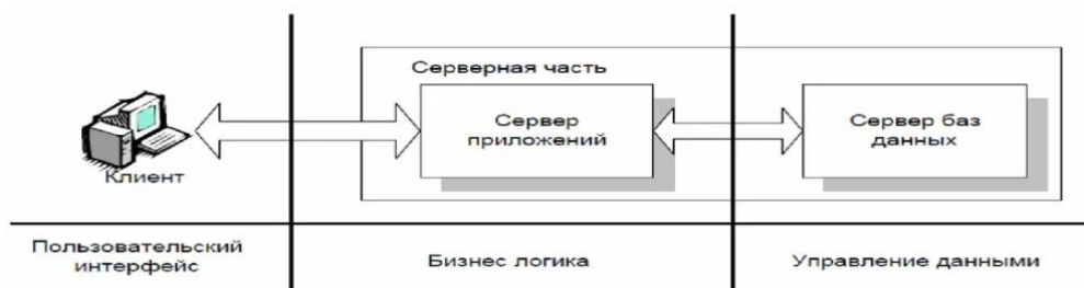
Рисунок 8 – Трехзвенная архитектура «клиент-сервер»
