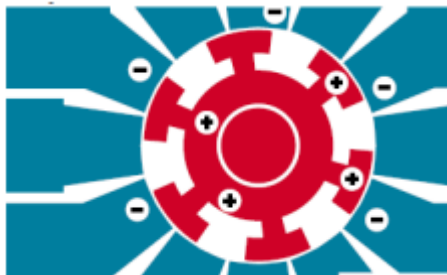
Рисунок 5 – Схема работы электростатического привода [17]
