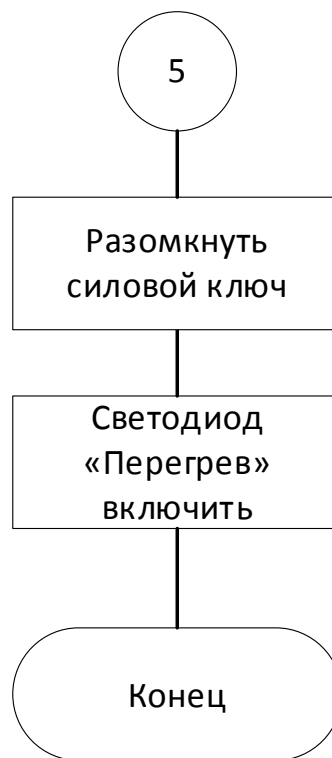
Рисунок 12 – Блок-схема алгоритма защиты от перегрева
