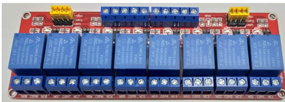
Рисунок 26 – Релейный модуль
