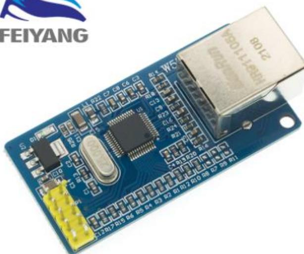
Рисунок 30 - Ethernet shield
