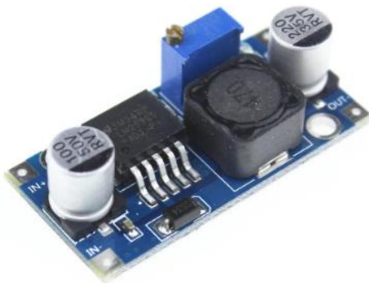
Рисунок 28 – Преобразователь напряжения
