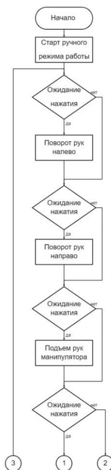
Рисунок 54 – Блок схема действий, выполняемых манипулятором
