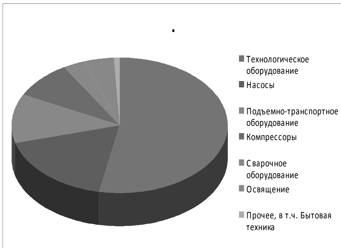
Рисунок 4 - Соотношение установленных мощностей электроприемников
