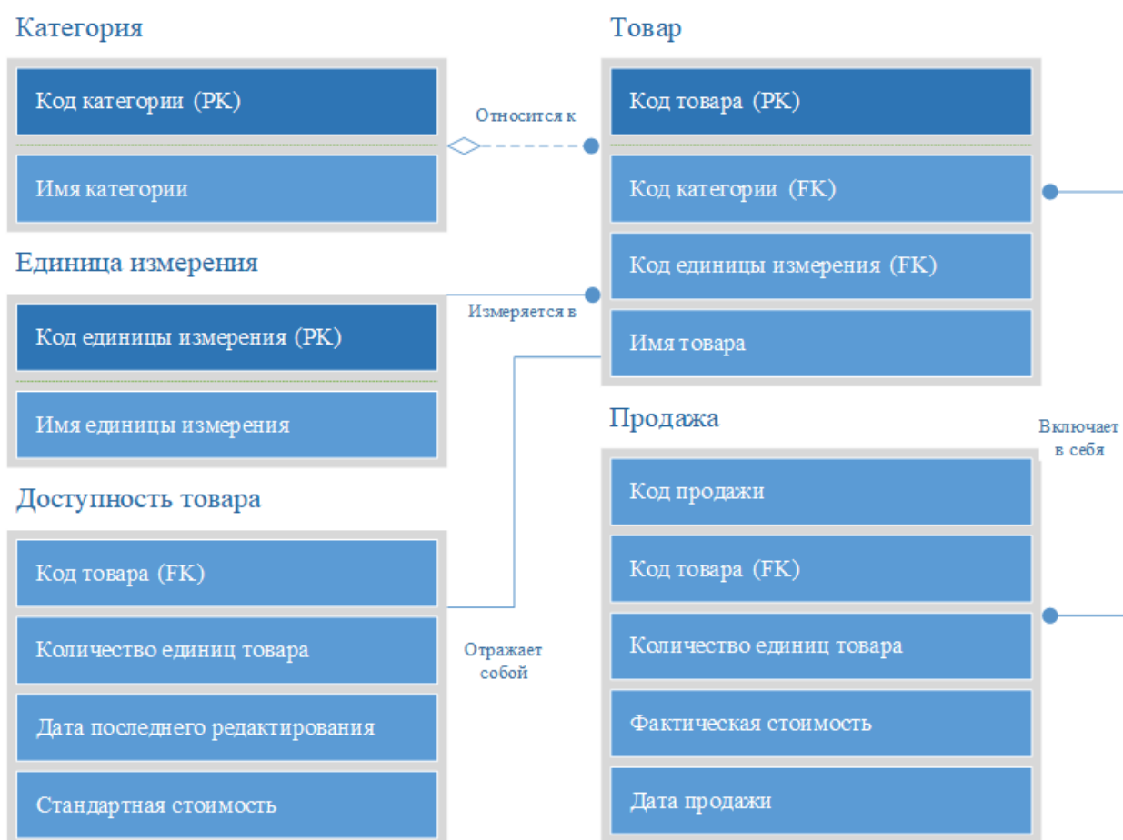
Рисунок 12 – Логическая модель базы данных информационной системы
