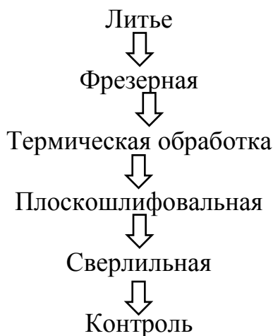
Рисунок 4 – Последовательность операций восстановления детали
