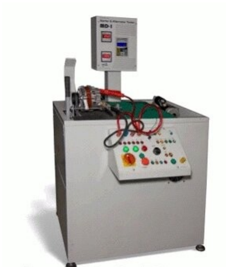
Рисунок 3 – Стенд для проверки генераторов, реле–регуляторов и стартеров, системы зажигания MD–2
