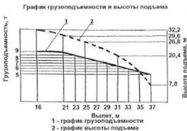
Рисунок 3.2 – Грузовая характеристика башенного крана КБ-404
