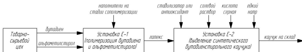
Рисунок 1 – Структурная схема производства синтетического бутадиен-стирольного каучука
