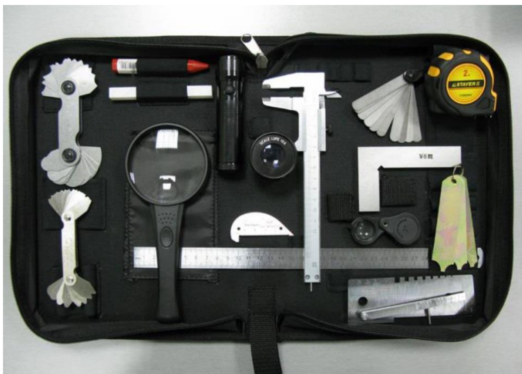
Рисунок 11 – Оборудование для проведения визуально-измерительного контроля
