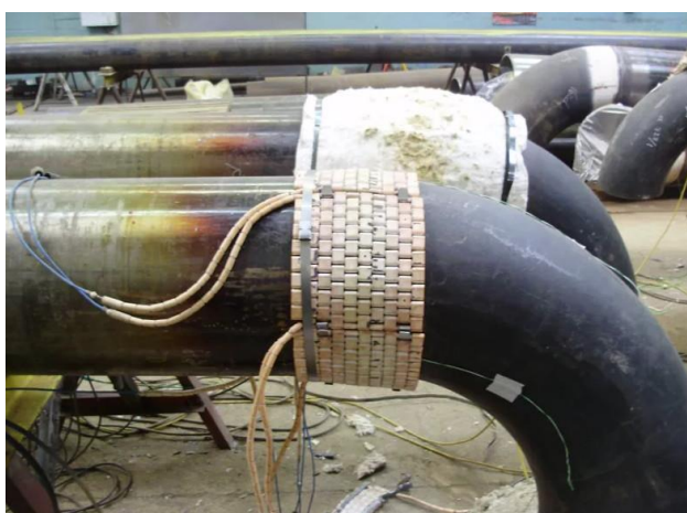
Рисунок 15 – Индуктивный подогрев трубы
