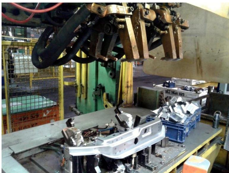
Рисунок 8 – Контактная точечная сварка на многоэлектродной сварочной машине
