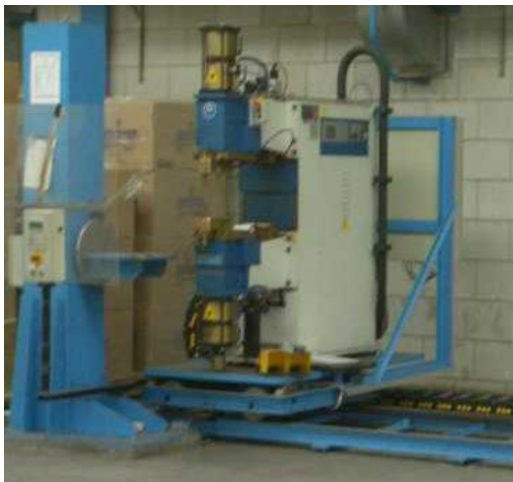
Рисунок 24 – Машина PPN 135 постоянного тока с промежуточным звеном повышенной частоты
