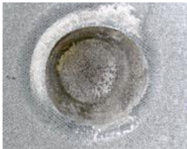
Рисунок 27 – Снимки соединений, выполненных контактной точечной сваркой по циклу №1
