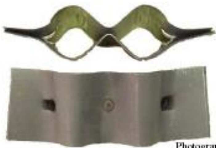
Рисунок 8 – Динамическое испытание с разрушением долотом DP 600 при 0,65 + 1,3 мм
