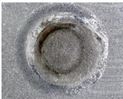
Рисунок 28 – Снимки соединений, выполненных контактной точечной сваркой по циклу №2
