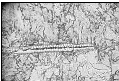
Рисунок 12 – Включения цинка (x100)
