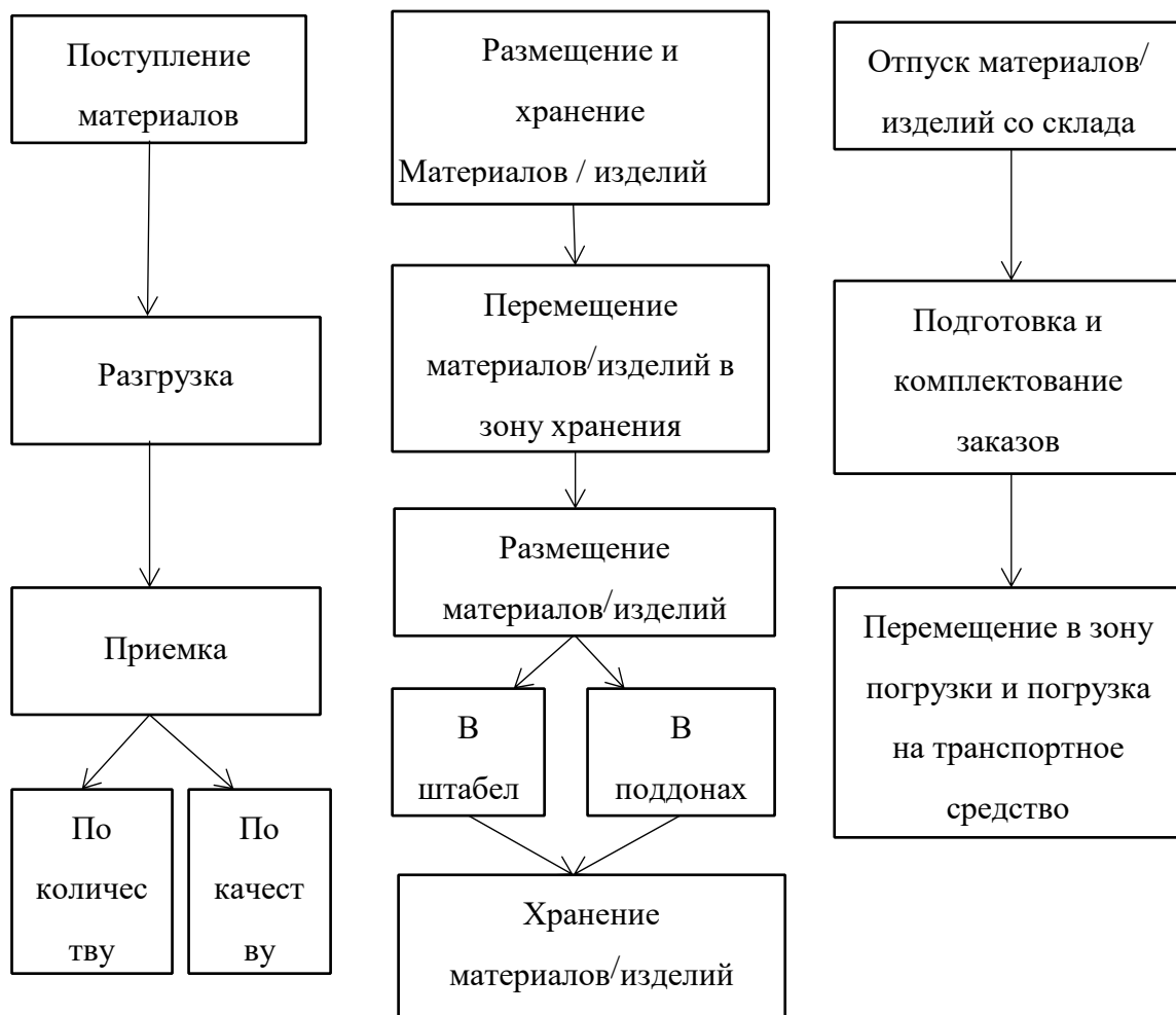
Рисунок 1 - Схема складских логистических процессов в ООО «Озон»
