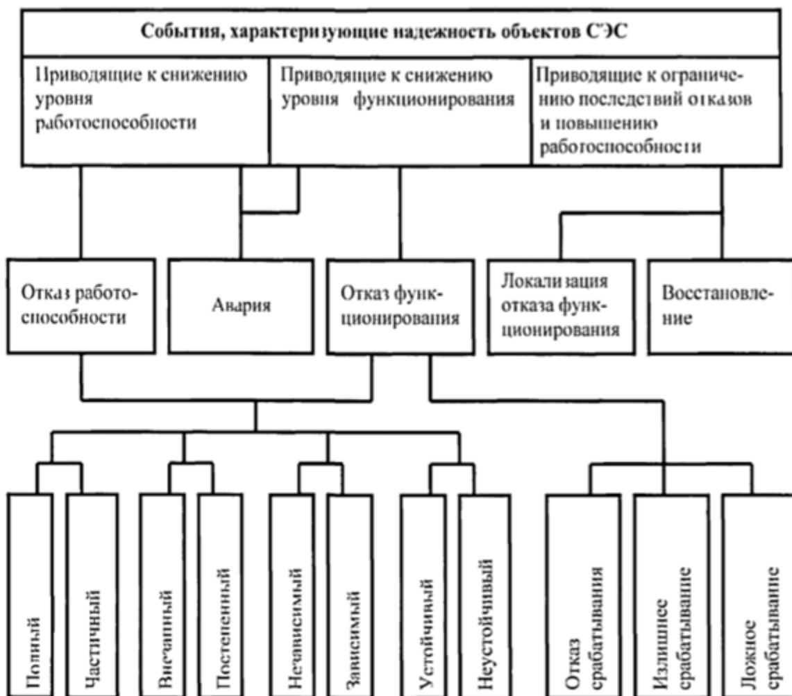
Рисунок 5 - Классификация событий, характеризующих надежность объектов систем электроснабжения
