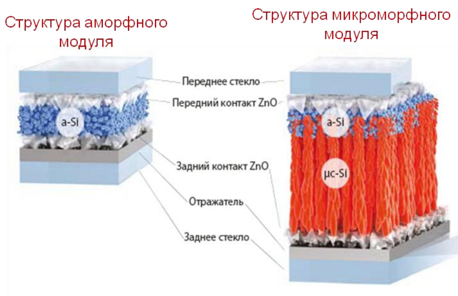
Рисунок 23 – Структура тонкоплёночных модулей на аморфном кремнии
