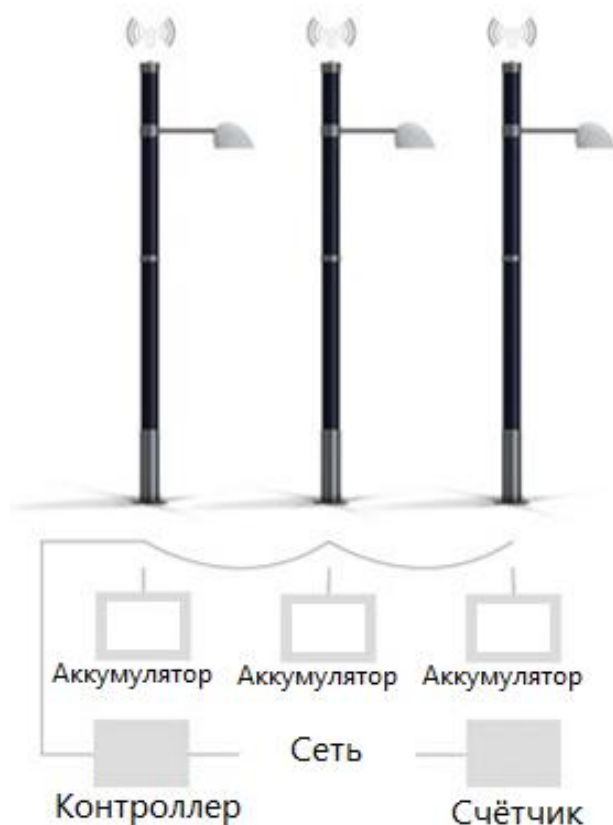
Рисунок 9 – Безопасное, бесперебойное функционирование, режим Safe
