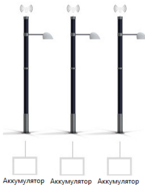
Рисунок 8 – Автономная работа, режим Plug & Play
