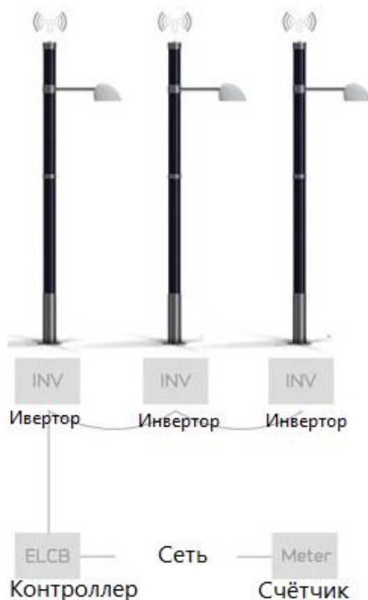
Рисунок 10 – Активный режим Active, подключение к сети через инвертор
