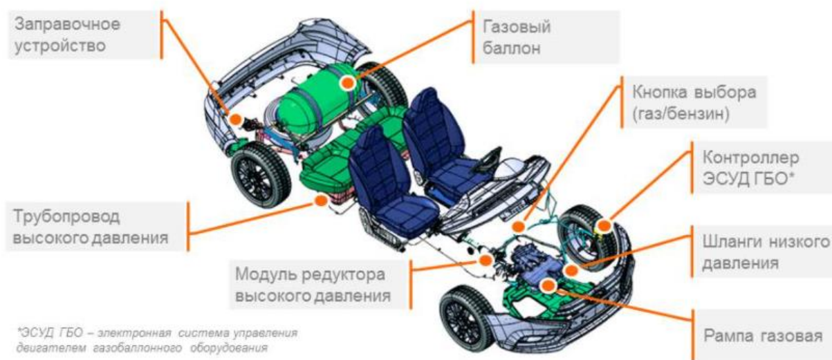
Рисунок 3 – Компоновка оборудования LADA Vesta CNG
