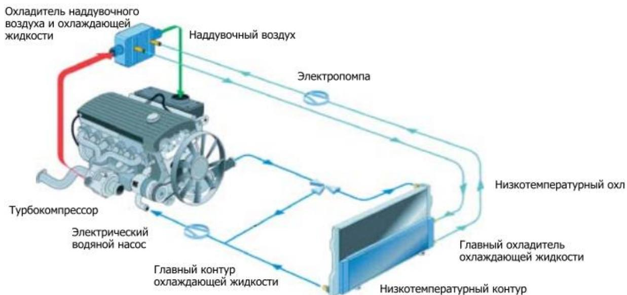
Рисунок 7 – Примерная схема непрямого охлаждения наддувочного воздуха через низкотемпературный охладитель.
