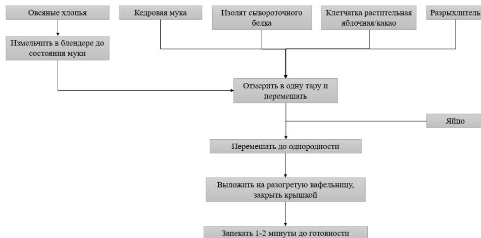
Рисунок 3 – Технологическая схема производства вафель с кедровой мукой и клетчаткой растительной яблочной/клетчаткой растительной яблочной и какао
