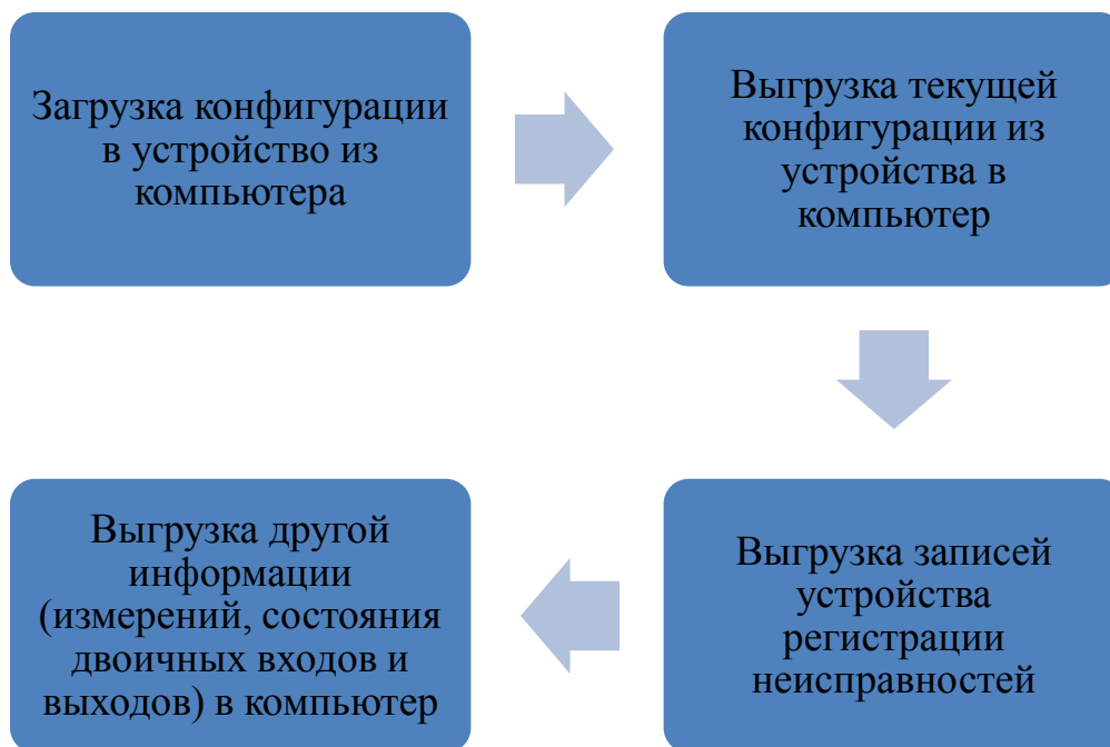
Рисунок 2.10 – Операции, выполняемые при использовании соответствующего кабеля и сервисной программы
