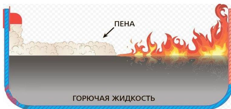
Рисунок 24 – Сущность пенного пожаротушения
