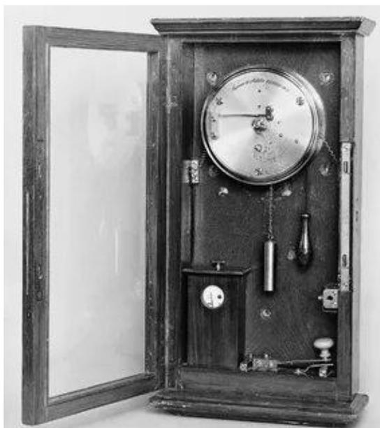
Рисунок 1 – Ручной пожарный извещатель фирмы «Сименс и Гальске»
