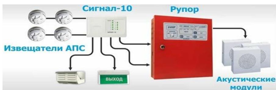
Рисунок 18 – СОУЭ третьего типа
