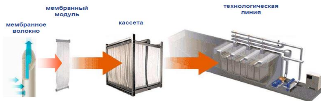
Рисунок 4 - Мембранная установка для очистки водного стока
