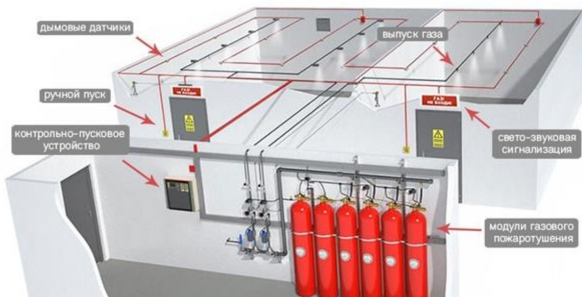
Рисунок 3 – Пример размещения установок хранения газового огнетушащего состава, в нашем случае – хладон ФК-5-1-12 (3М™ Novac™ 1230)
