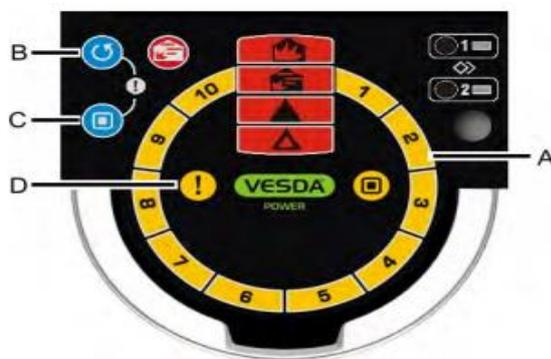
(A – индикатор Smoke Dial, B – кнопка Reset, C – кнопка Disable, D – Сигнал неисправности)
