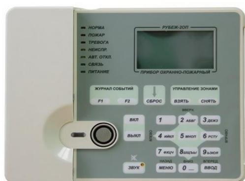
Рисунок 8 – Прибор адресный охранно-пожарный Рубеж-2ОП
