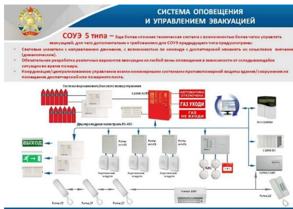
Рисунок 14 – Система оповещения и управлением эвакуацией
