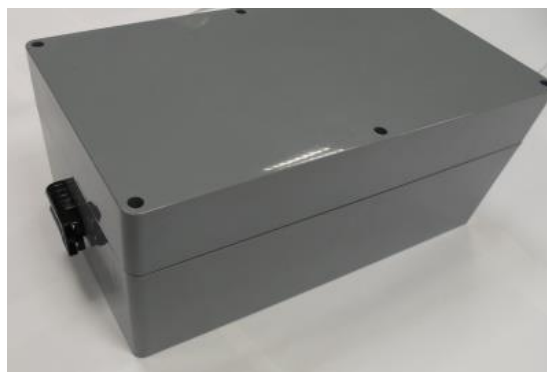
Рисунок 19 – Аккумуляторная батарея LiFePO 4 , 48В-24 А·ч
