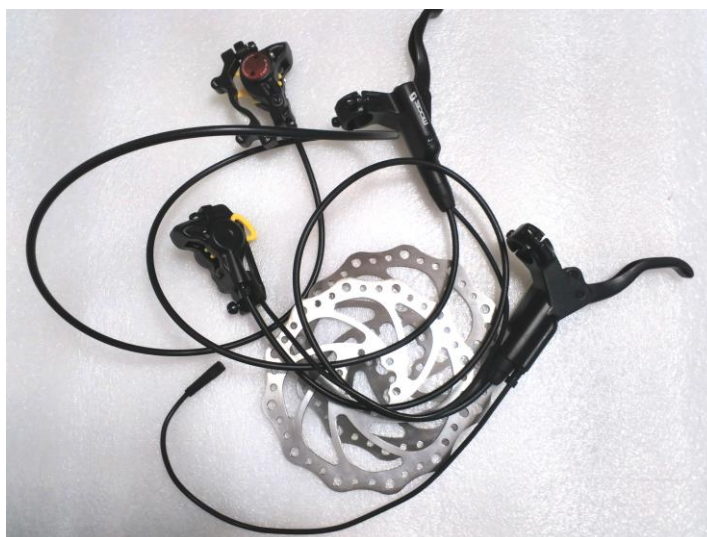
Рисунок 16 – Совмещённый гидравлический и электронный тормоз МР-4(5) и SMP-4(5)
