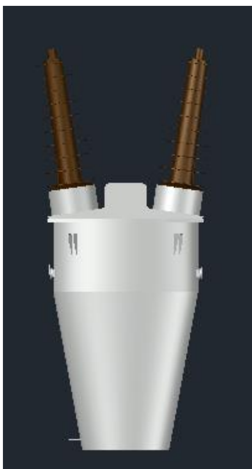
Рисунок 6 – Присоединение крышки и двух высоковольтных вводов
