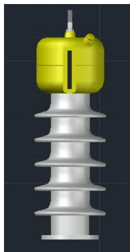
Рисунок 13 – Моделирование расширителя, маслоуказателя и зажима
