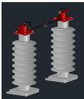
Рисунок 23 – Изолятор с главными ножами
