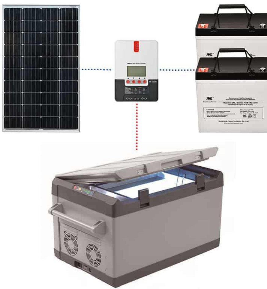
Рисунок 13 – Солнечная электростанция «Холодильник»
