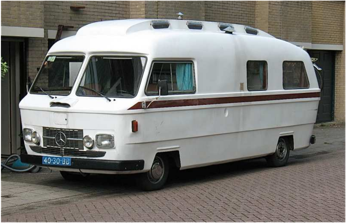
Рисунок 7 – Кэмпervан с крышей «high top» на базе микроавтобуса Мерседес
