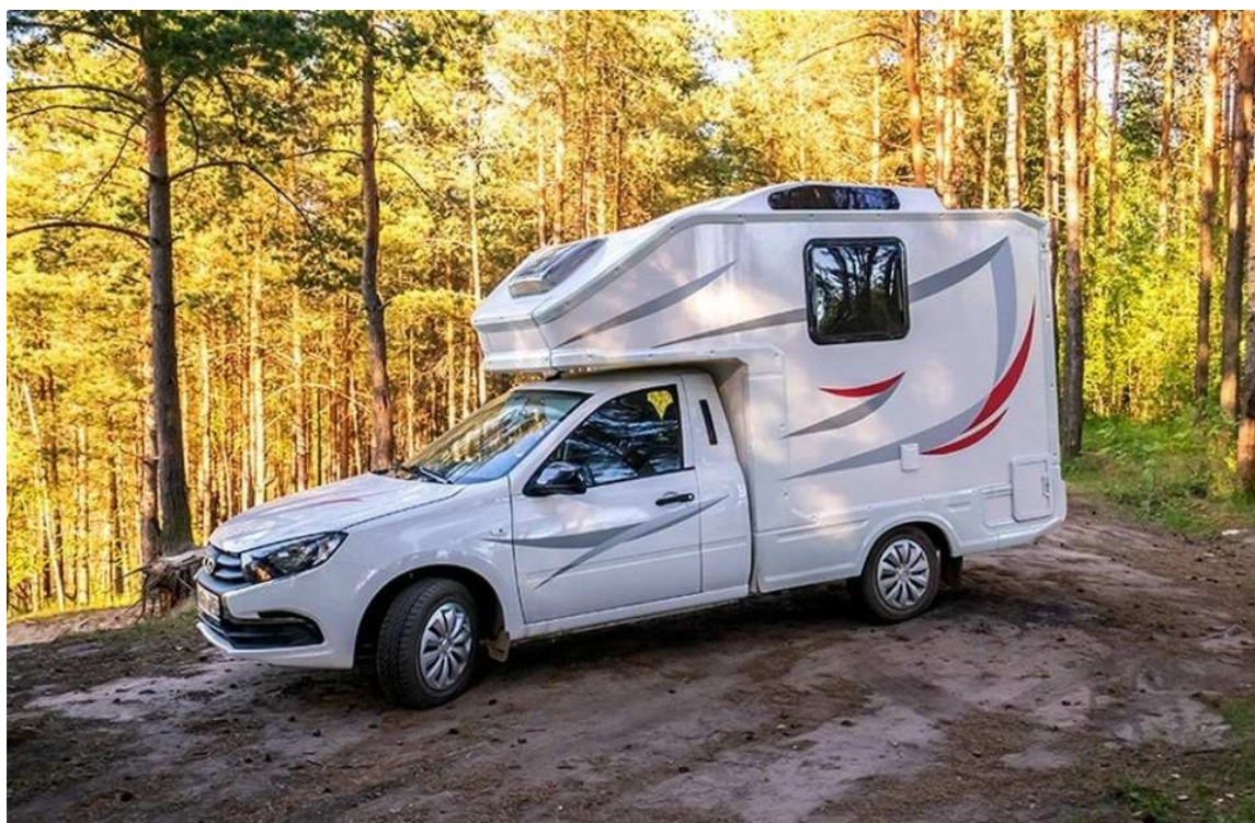
Рисунок 10 – Кемпер на базе автомобиля Лада Гранта
