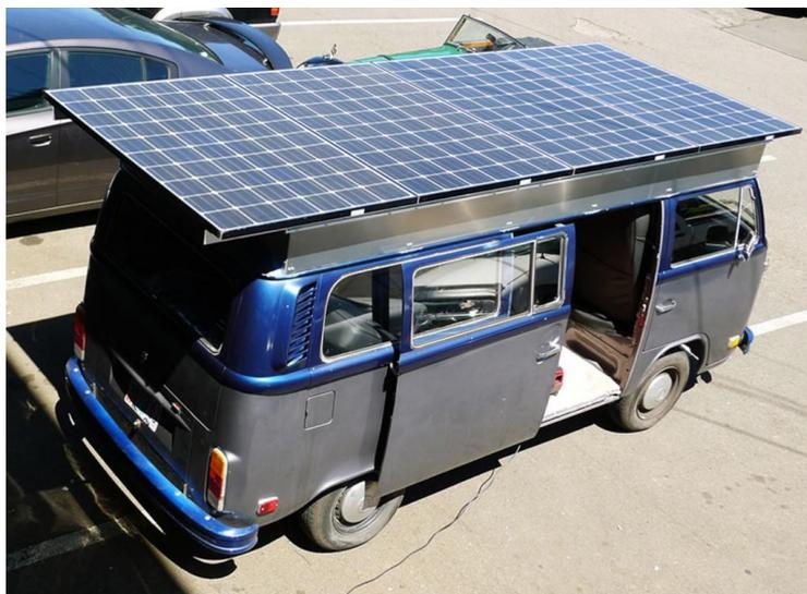
Рисунок 21 – Размещение солнечной панели на крыше транспортного средства
