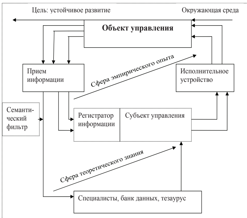
Рис. 10. Механизм управления с двумя контурами регуляции, обеспечивающий устойчивое развитие системы
