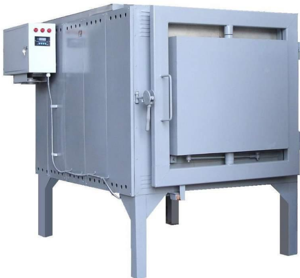
Рисунок 10 – Печь сопротивления нагревательная с окислительной атмосферой.
