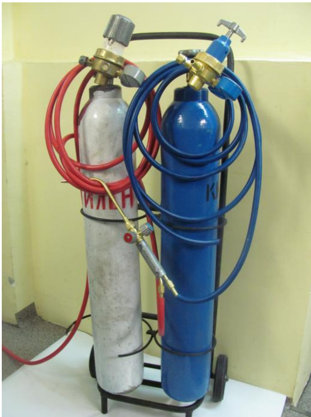
Рисунок 6 - Оборудование для пайки нагревом газовым пламенем.
