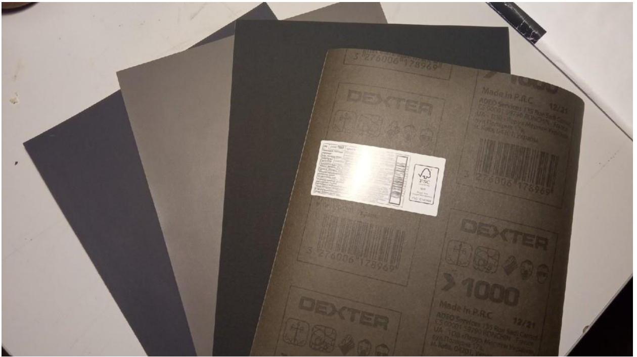
Рисунок Б.18 Бумага разной абразивности для шлифовки. Фото: Некрасова В.М., гр. ДПИб-1801а. 2022 г.
