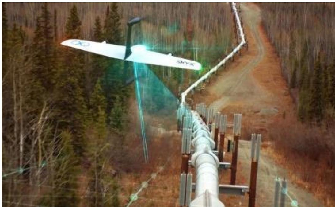
Рисунок 6 – Обнаружение утечек углеводородов с помощью БПЛА
