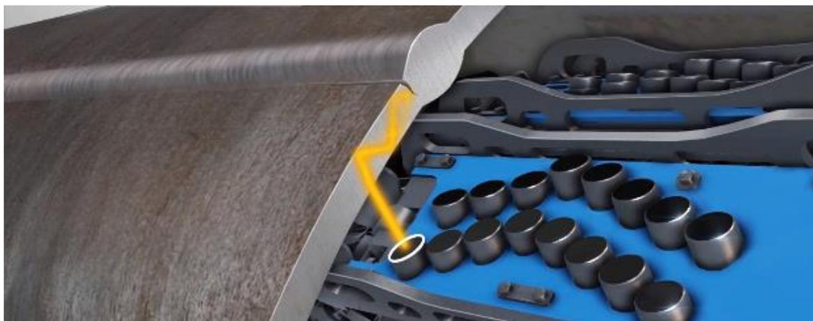
Рисунок 4 – Технология обнаружения трещин в нефтепроводе
