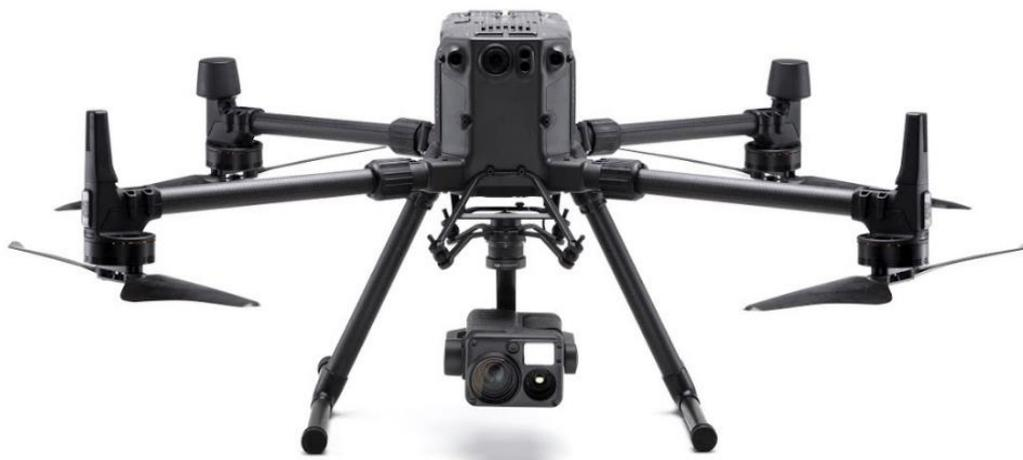
Рисунок 18 – Квадрокоптер, оснащенный цифровой инфракрасной видеокамерой высокого разрешения
