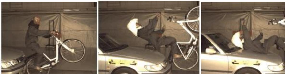
Рисунок 11 – Испытание устройства защиты головы
