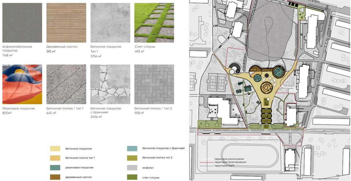
Рисунок Б. 37 – Аналог 3. Схема устройства покрытий
