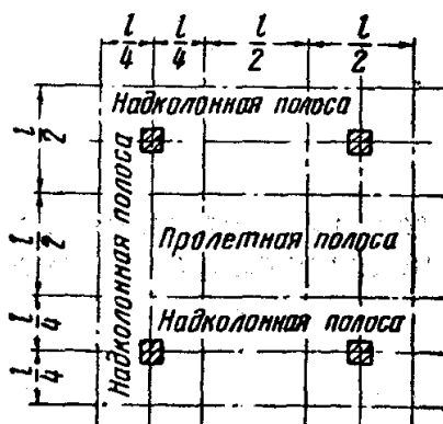
Рисунок 2.1 – Распределение полос монолитного перекрытия
