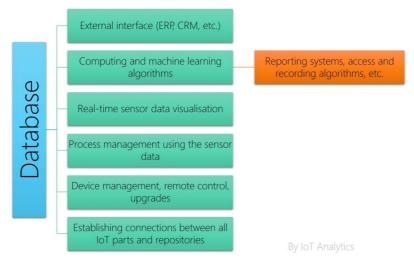
Fig. 6.12. IIoT Functions
