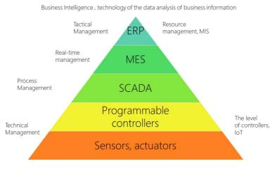
Fig. 2.30. An Automation Pyramid
