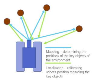
Fig. 6.2. Robot Mapping
