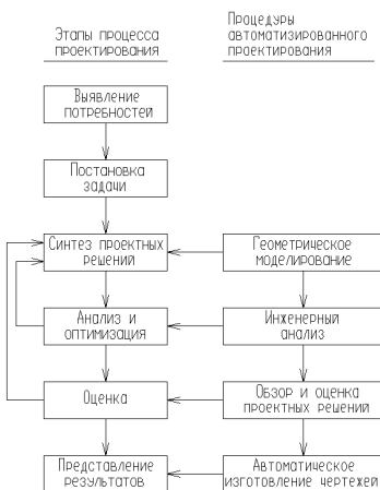
Рис. 3. Область использования ЭВМ в процессе проектирования
