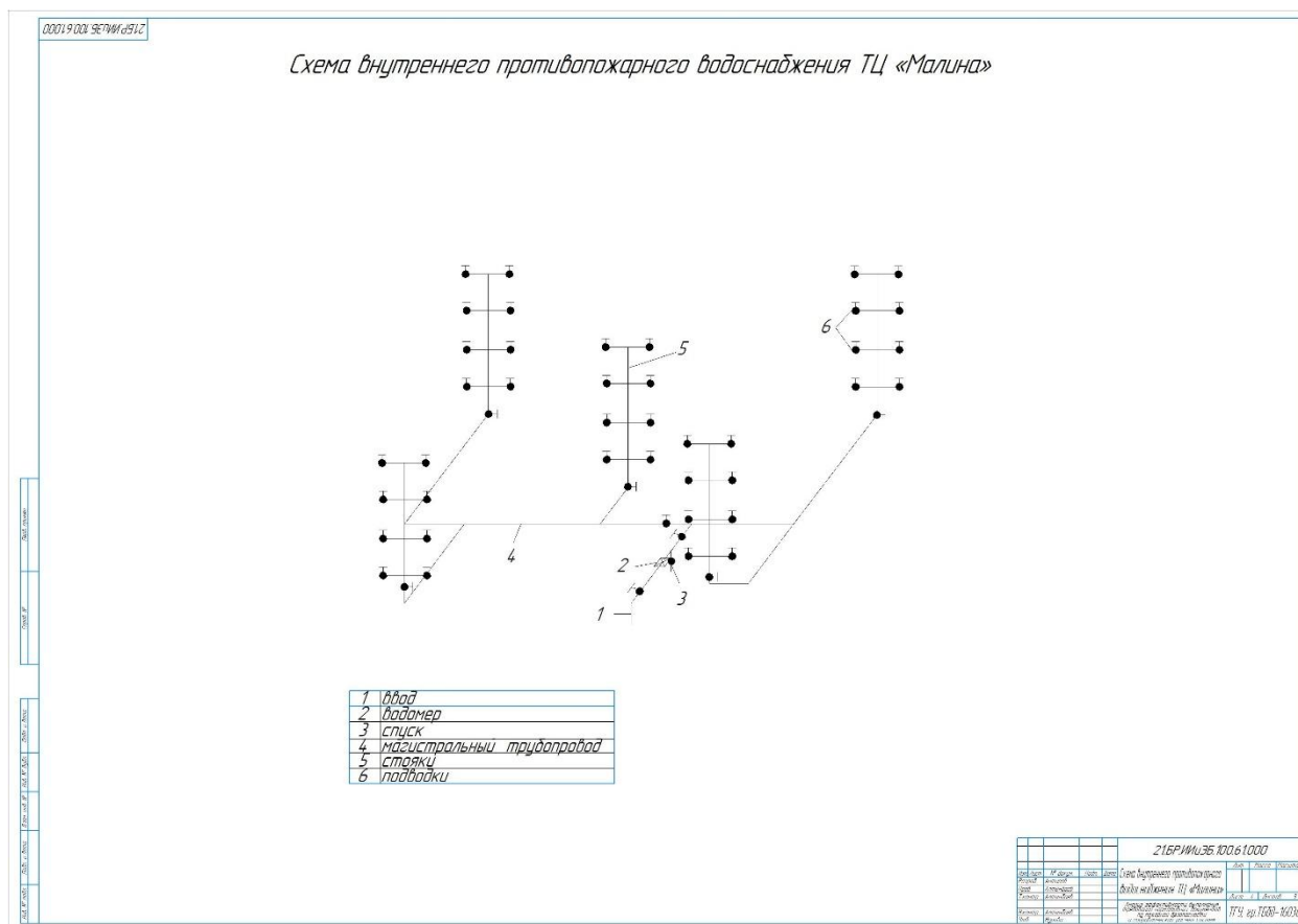
Рисунок 5 – Схема внутреннего водоснабжения ТЦ «Малина» на первом этаже
